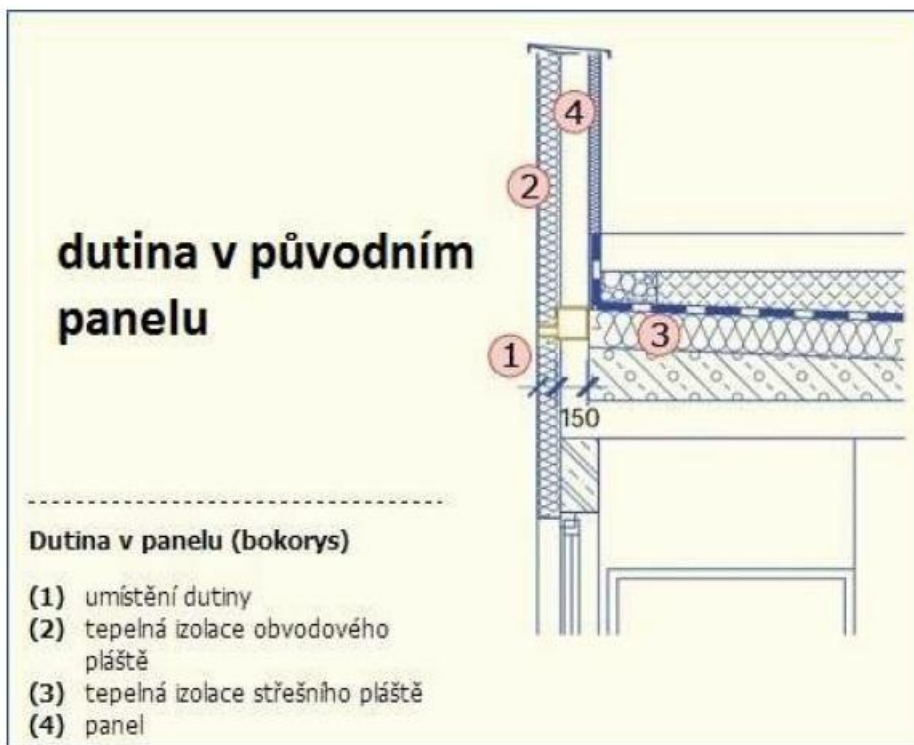
Obr. 8: Návrh tvorby nové dutiny v panelovém prvku v místě stávajících ventilačních otvorů.
