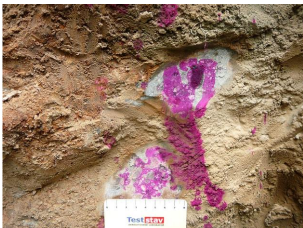
Pohled na vybroušená zkušební místa pro zkoušku pevnosti, fialová barva je po zkoušce karbonatace roztokem fenolftaleinu.
