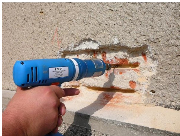
Zkušební návrť Kučerovou vrtačkou do malty v ložné spáře pro zjištění pevnosti.
