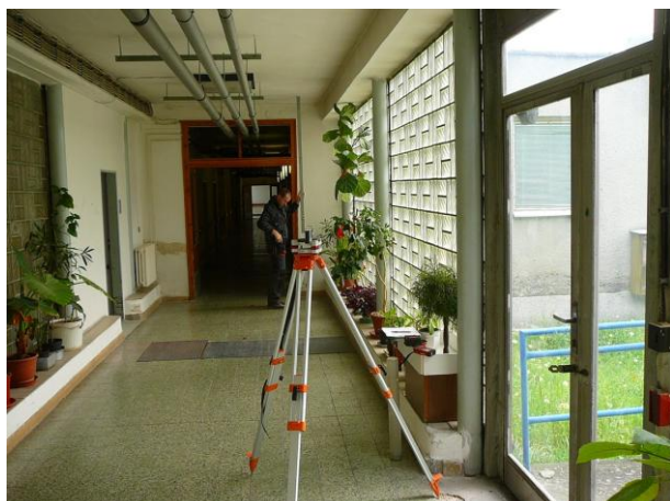
Měření průhybu stropní konstrukce.
