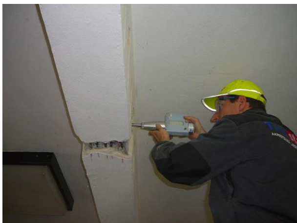
Zkoušení pevnosti betonu schmidtovým tvrdoměrem.
