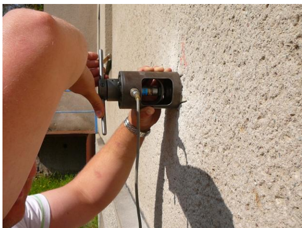
Zkouška přídržnosti omítky na objektu hlavní budovy.
