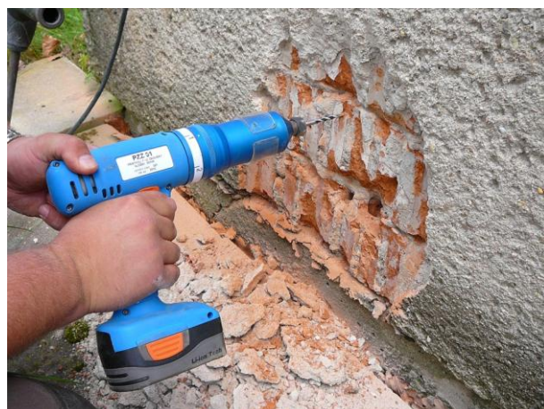
Zkouška pevnosti zdiva na severní zdi.
