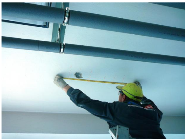
Měření vzdáleností mezi nosnou výztuží zjištěnou nedestruktivním způsobem.
