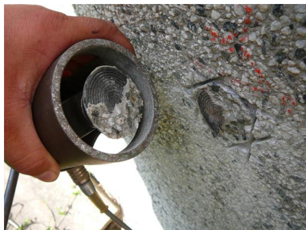
Detailní záběr na terč po zkoušce, naměřená hodnota 4,264 MPa.
