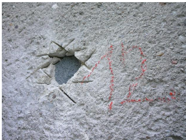
Zkušební místo 12 po odtrhové zkoušce.
