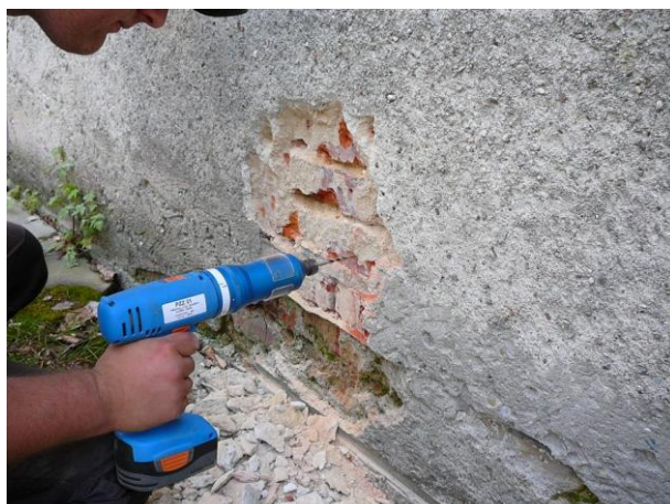
Zkoušení pevnosti zdiva na severní stěně v místě 9.
