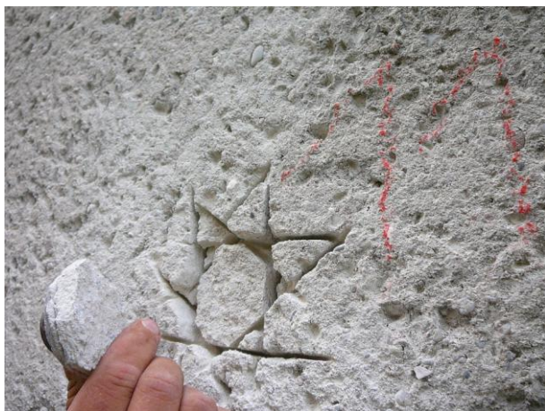
Zkušební místo 11 po odtrhové zkoušce.
