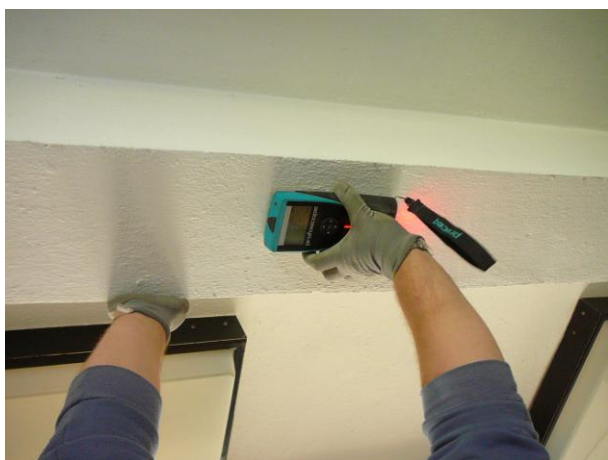
Nedestruktivní vyšetření jednoho z trámů v protilehlém traktu.
