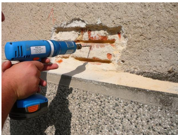
Zkušební návrť Kučerovou vrtačkou do cihly pro zjištění pevnosti.
