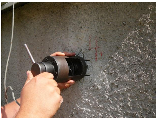
Zkouška přídržnosti omítky v místě 4 na objektu SO 002.
