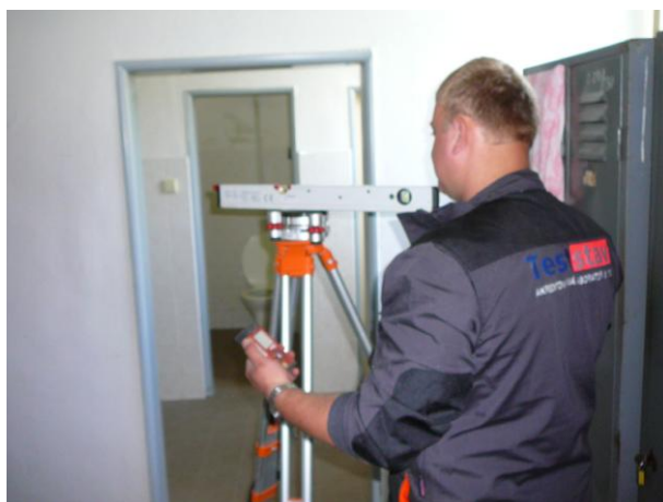
Instalace stativu s vodováhou pro měření průhybů stropní konstrukce.
