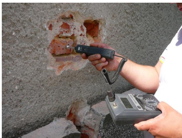
Kontrolní měření vlhkosti přístrojem GANN.
