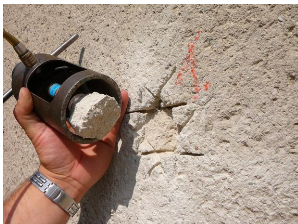
Zkušební místo 1 po zkoušce, porucha v jádrové omítce při 0,163 MPa.
