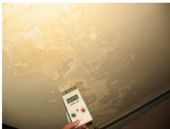
11,12 Místo odběru vzorku č. 2 na výskyt povrchových kolonií plísní na vlhkém zdivu v koutě chodby
