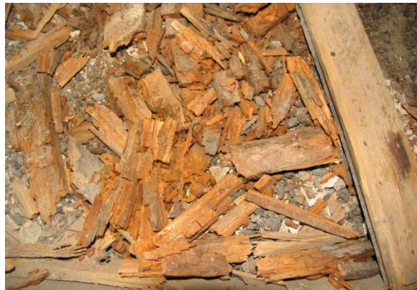
3. Detail napadené dřevní hmoty
