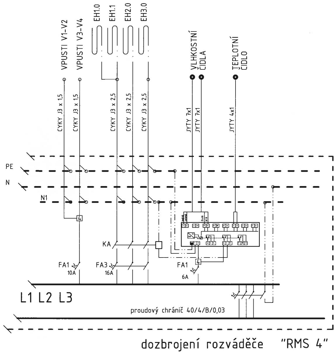
Rozvodná soustava: 3/PE/N/AC, 50 Hz, 400/230V
